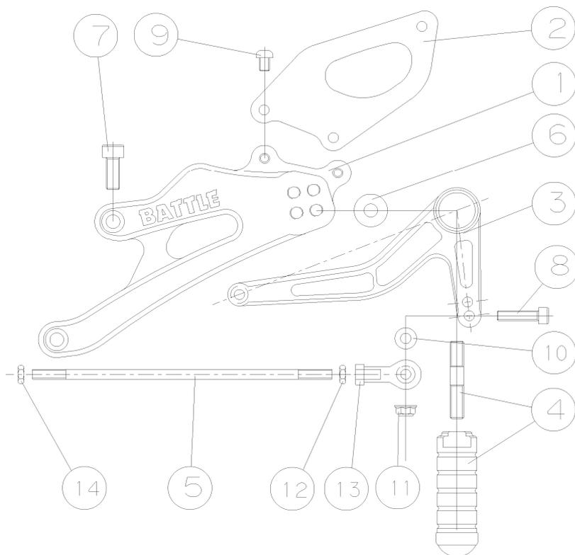
※ 組付け後、ペダルを一杯に動かして、各ギアでロッドエンドがホルダーやステップに接触していないか確認してください。接触していると、走行時に変速できない場合があります
