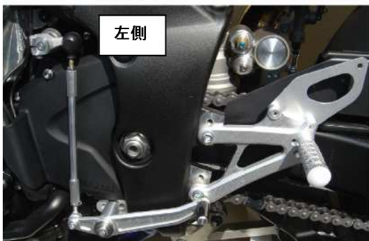
逆シフト組み付け例（シフトアーム後向き）
